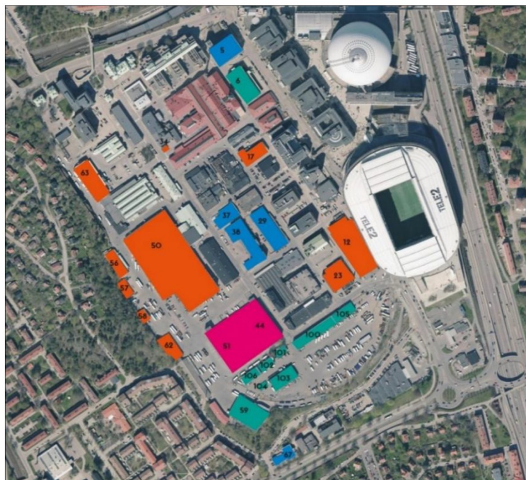
Figur 16. Byggnader markerade med cerise/rosa, grönt och blå färg har rivits (med undantag för hus 29 som håller på att rivas i dagsläget). Byggnader med orange färg är de som planeras att rivas från 2021 och framåt.
