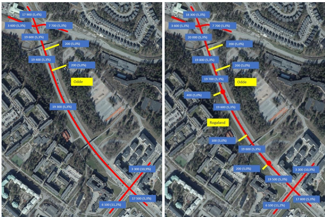
Figur 4. Trafikuppgifter angivet för årsmedeldygn (ÅDT) för år 2040, nollalternativet till vänster samt utbyggnadsalternativet till höger. Andel tunga fordon visas inom parentes. Trafik som använts i beräkningarna för nollalternativet och utbyggnadsalternativet kommer från COWI [4].
