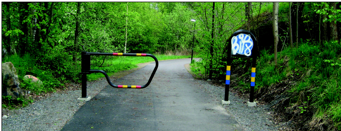
Hinder och pollare i Huddinge som försetts med reflexer och har väl tilltagen bredd mellan hinder och pollare.
