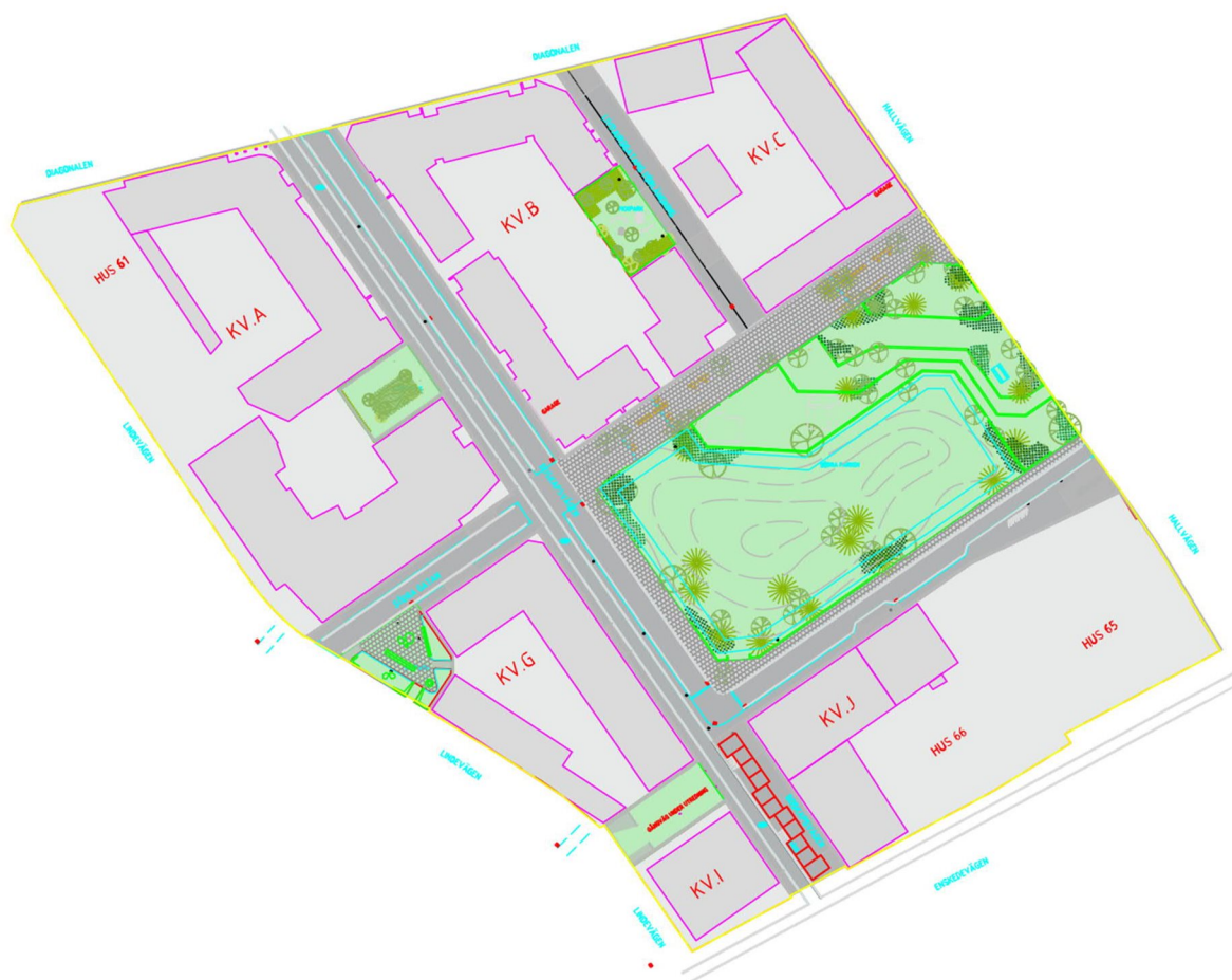
Figur 7. Framtida markanvändning. Mörkgrå ytor är asfalterade vägar, skrafferad grå yta är gångbana, gröna ytor är parkområden och ljusgrå ytor är kvartersmark där byggnaderna inom fastigheten är markerade med rosa polygoner.
