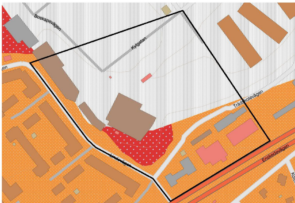
Figur 4. Planområdets geologiska förutsättningar från SGU:s jordartskarta. Grårandig yta är fyllning, röd yta med prickar är urberg med ett tunt eller osammanhängande lager av morän, orange är postglacial sand. Detaljplanens ungefärliga yta markerad med svart polygon.
