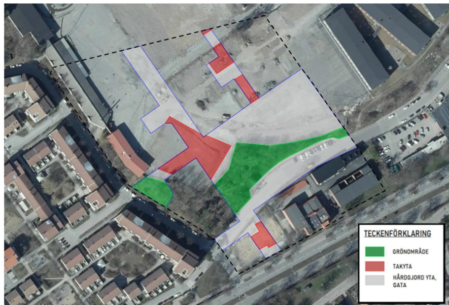
Figur 6. Befintlig markanvändning. Tidigare takytor har markerats i den planerade allmänna platsmarkens yta (blå prickad linje). Svart streckad linje visar hela detaljplanens yta. Ortofotot i bakgrunden visar hur området är under transformation, samt var nuvarande hårdgjord yta, gata och grönområde ligger i förhållande till detaljplanen.
