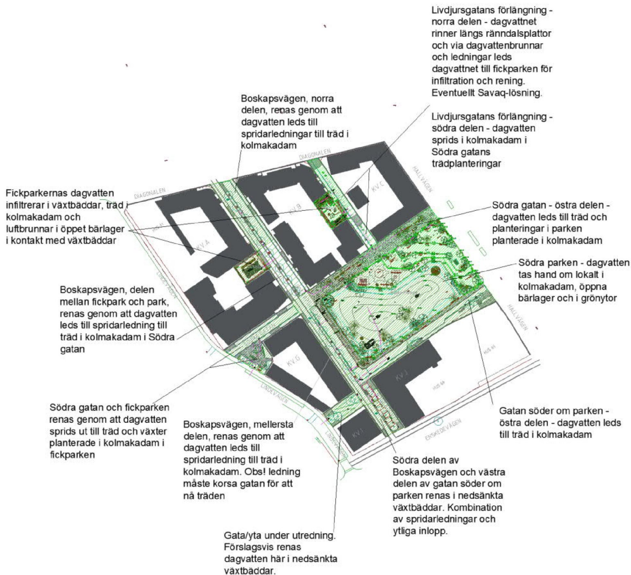
Figur 11. Dagvattenåtgärder på allmän platsmark – översikt. Alla ytor är grönstreckade vilket symboliserar att de hanteras genom infiltration till växtytor.
