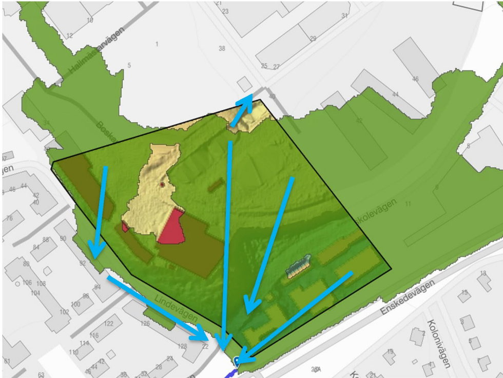
Figur 8. Ytligt avrinningsområde för nuvarande situation. Blå pilar visar flödesriktning för ytlig avrinning. Det gula området vid de rödmarkerade byggnaderna är en lokal sänka.
