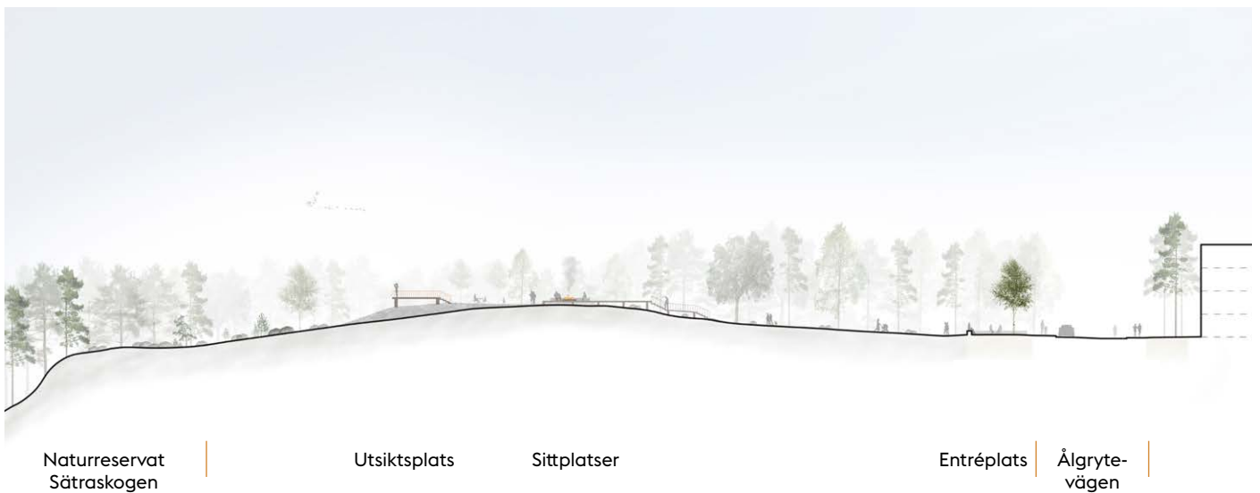
Sektion D-D 1:400. Sektion visar dramatiska höjdförhållanden från Ålgrytevägen ner mot naturresevatet.
