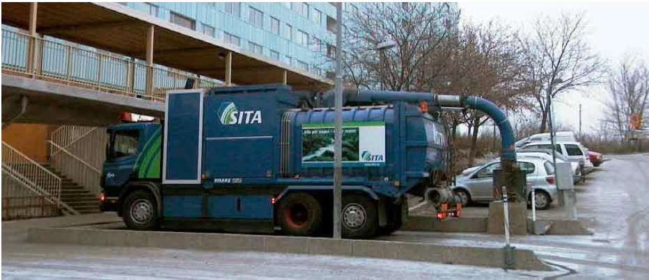
Figur 4, Sopsugsbil under tömning, markförlagd dockning med låsbar överdel
