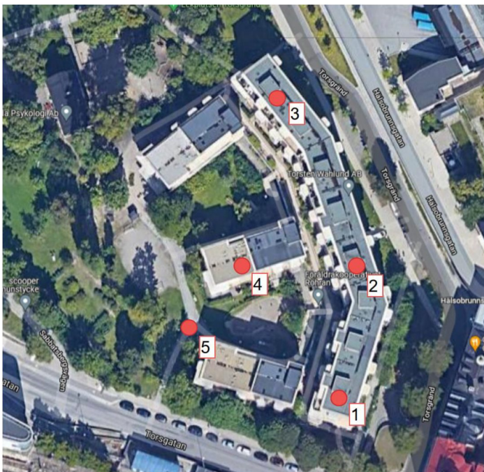
Figur 1: Ungefärliga mätpunkter markerade som röda cirklar på karta. I byggnad på garagegolv och utanför byggnad på mark/brunnfundament.
