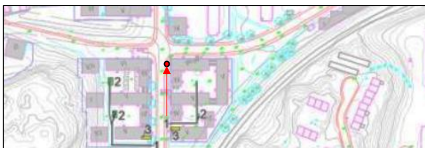
Figur 8. Exempel på placering av dockningspunkt (se röda cirklar) som är mer fördelaktig ur bullersynpunkt i kvarter 3 och 4.
