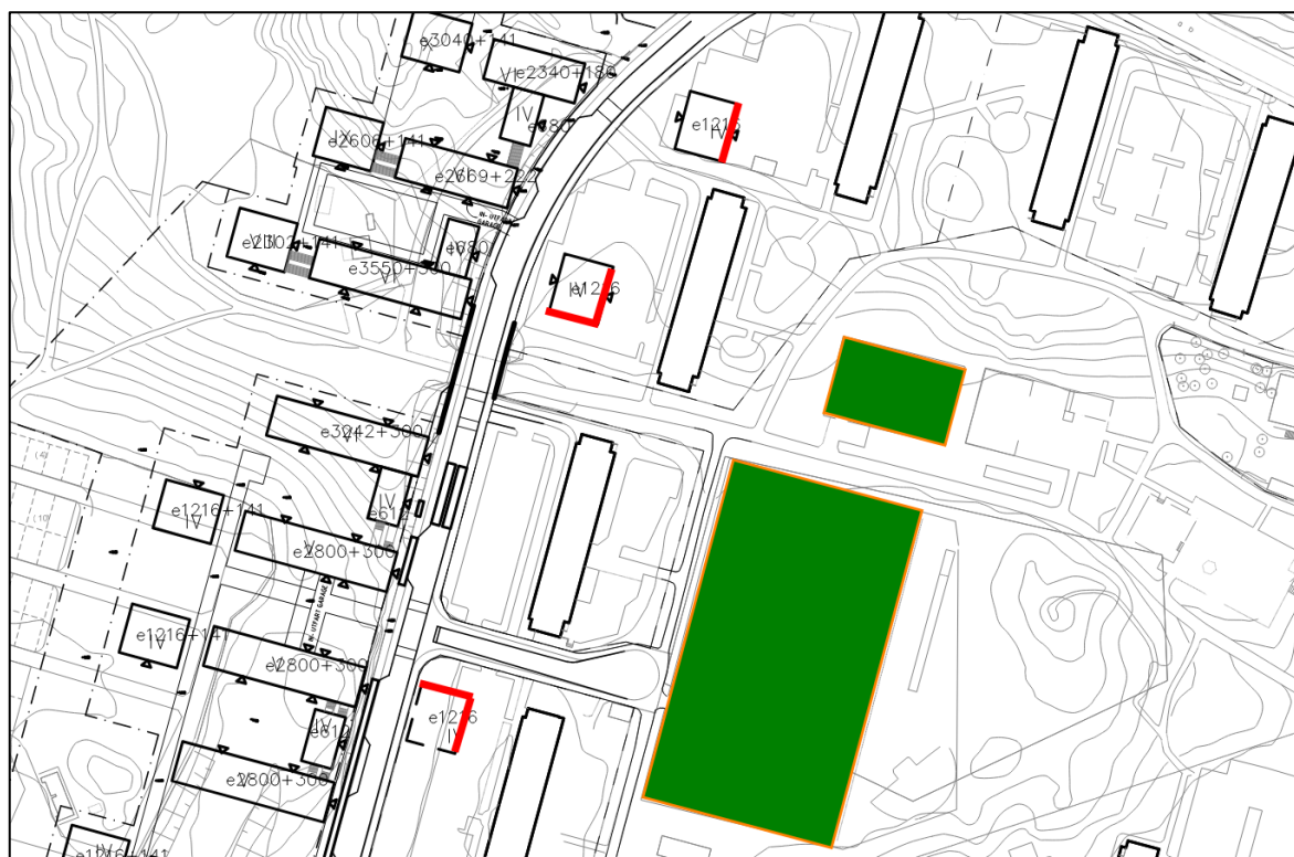
Figur 5. Fasader som vetter mot öppningar i befintlig bebyggelse mot idrottsanläggningen där god ljudisolering rekommenderas.
