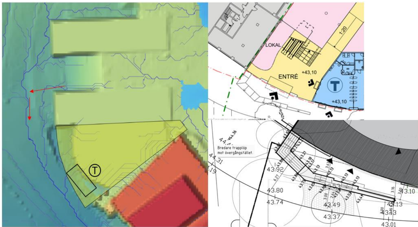
Figur 16 Till vänster flödesstråk vid skyfall kring entrén till tunnelbanan i nordöstra delen av Arenavägen, gul polygon visar byggnaden där tunnelbaneentrén ligger. Röda pilar markerar alternativ flödesväg norr om området för att ytterligare minska risken för översvämning. Utdrag från Scalgo. Till höger utklipp från: 210929_Arenavägen a3-justerad trappa-med höjder
