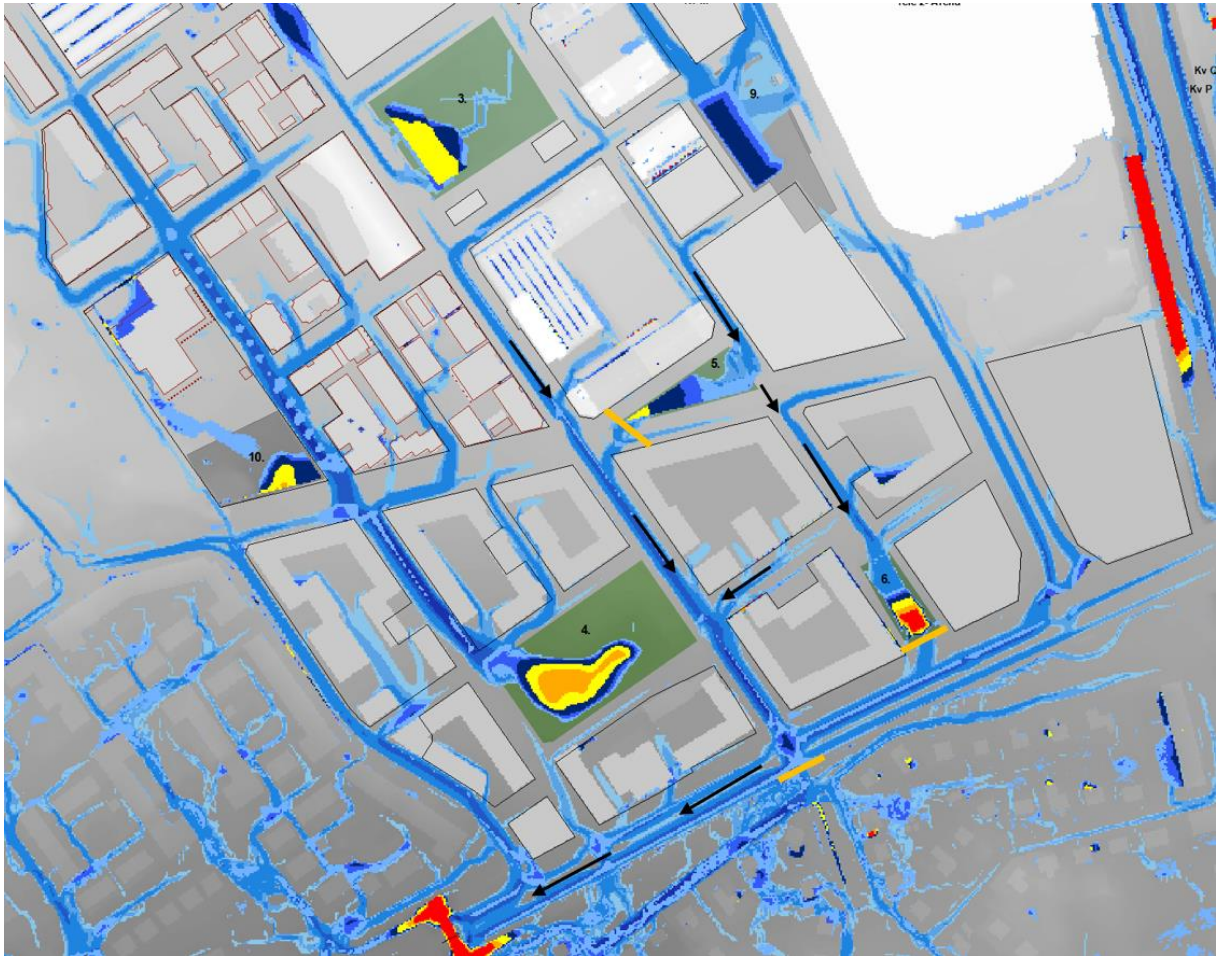
Figur 42 Svarta pilar visar hur flödet bör ledas för att minska belastningen till Hallvägen, Enskedevägen och villaområdet söder om Enskedevägen. Gula sträck visar var flödet bör stoppas för att minska belastningen.
