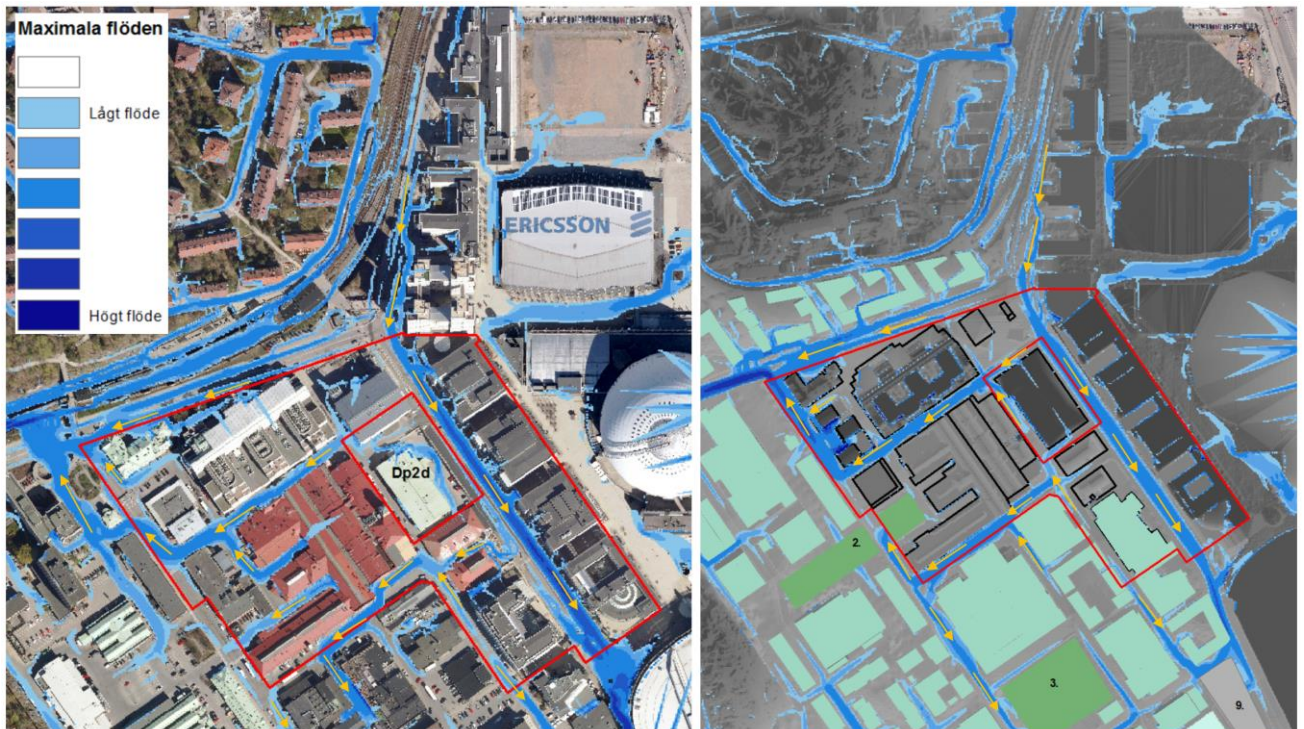
Figur 17 Beräknade maximala flöden (blåa fält), till vänster befintligt och till höger vid ny exploatering. Gula pilar visar flödesriktningen, röd polygon plangränsen, svarta rutor visar byggnader inom Dp2, turkosa polygoner byggnader utanför Dp2 gröna och gråa polygoner visar läge för skyfallsåtgärder (parker/torg).
