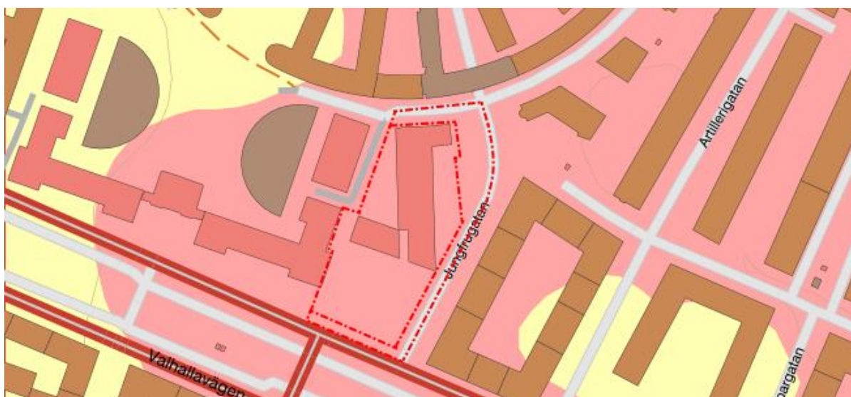
Bild 6, Genomsläpplighetskarta från SGU (2016) visande att aktuellt exploateringsområde bedöms ha hög (rosa raster) genomsläpplighet.
