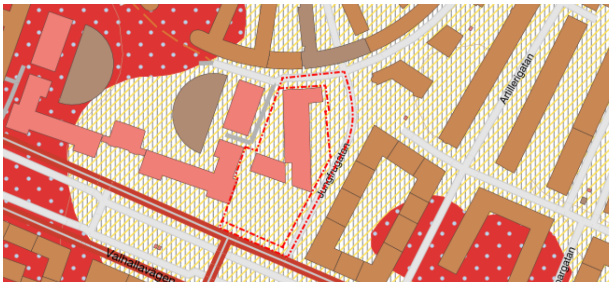
Bild 4, Jordartskarta från SGU (2016). gultstreckat raster representeras av fyllning som underlagras av postglacial lera, rödprickigt raster representeras av morän som underlagras av berg. Inre röd linje visar fastighetsgräns, yttre röd linje visar planområdesgräns.
