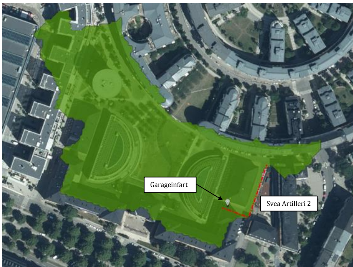
Bild 13, Tillrinning från nordväst, bedöms belasta parkeringsgarage på grannfastighet Svea Artilleri 14. Grå markering avser garageinfart, rödstreckad linje avser kantsten som avgränsar flödet.
