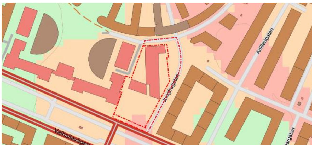
Bild 5, Jorddjupskarta från SGU (u.å.). Jordlager inom planområdesgränsen uppskattas vara mellan 5-10 meter (beige).
