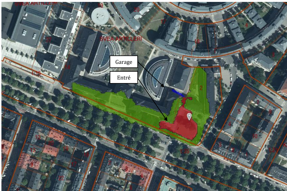
Bild 9, Lokal dämningsyta (rödmarkerat) med avrinningsväg (blåmarkerat) samt tillrinningsområde (grönmarkerat). Röda linjer avser fastighetsgränser.
