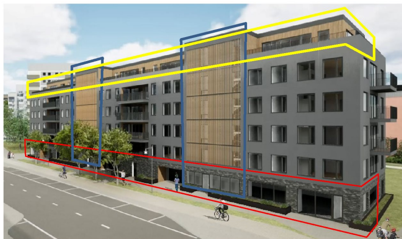
Detaljvy, sett från Maltesholmsvägen, som redogör för principerna med föreskrivna gestaltungsprinciper: indraget översta våningsplan (gul yta), antalet framskjutna trapphus mot vägen (blå ytor) samt den gestaltungsmissigt särskiljande bottenvåningen med andel genomsiktliga/uppglasade fasadytor (röd yta). Schare Arkitektur
