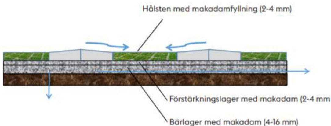
Figur 14. Principskiss av genomsläpplig beläggning. 25
