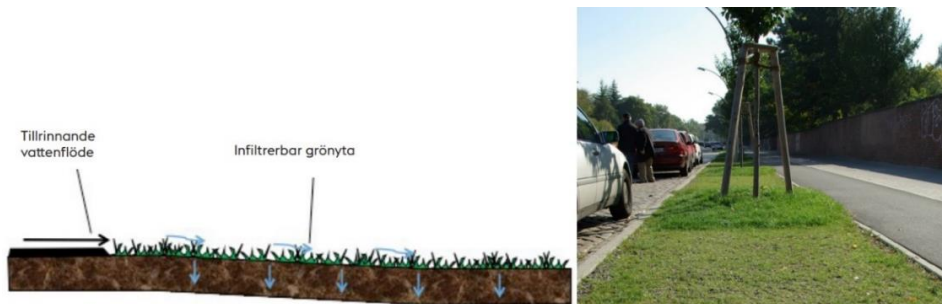
Figur 19. Principskiss nedsänkt grönyta (Stockholm Vatten och Avfall, 2017b).
