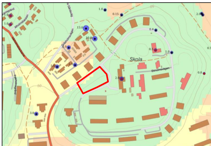
Figur 2-3. Jorddjupskarta (SGU, 2022). Skattat jorddjup på 0 m markeras med grönt, på 1-3 m med gröngrult, på 3-5 m markeras med gult och på 5-10 m med orange. Undersökningsområdet är markerat med rött. Jorddjupsobservationer med öppet avslut markeras med svart stjärna och jorddjupsobservationer med avslut mot berg med röd stjärna.
