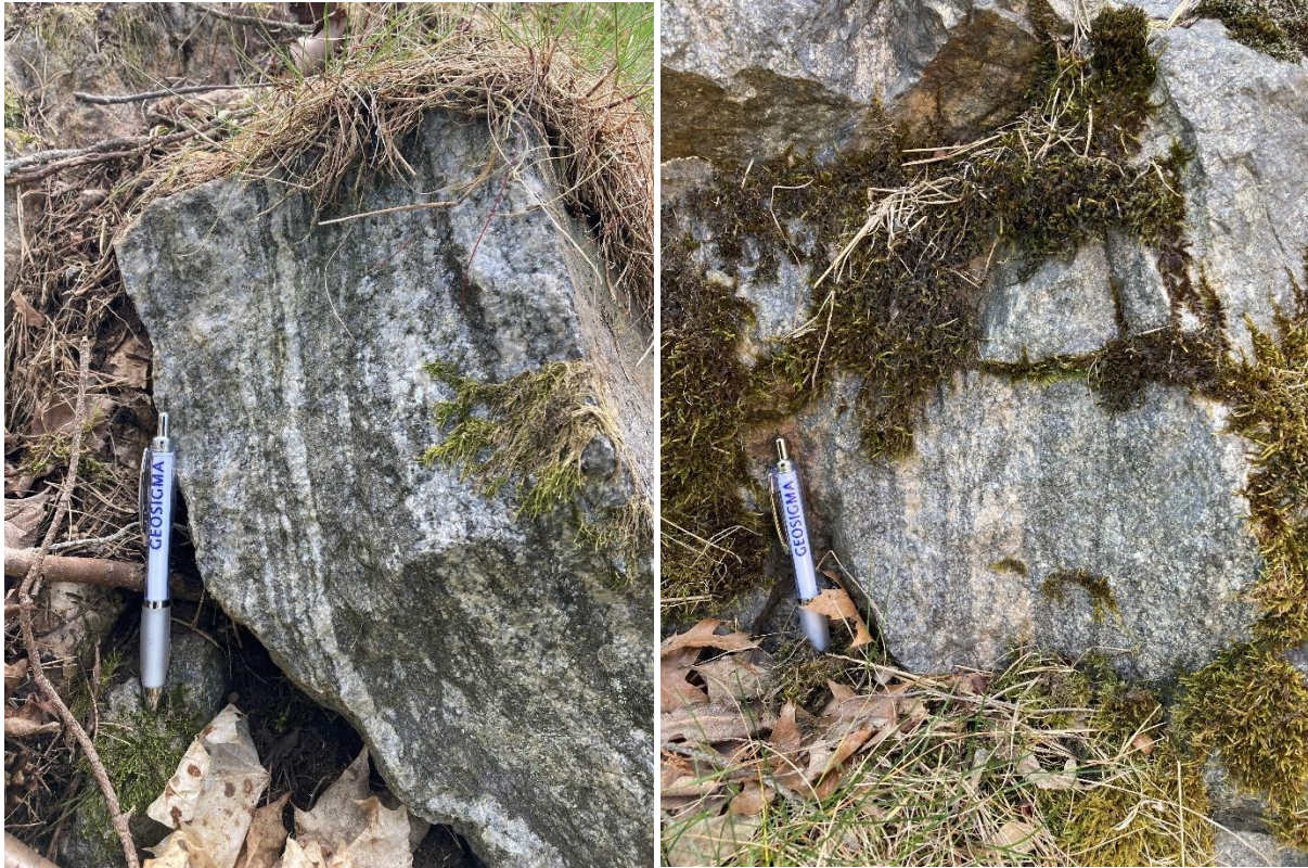
Figur 6-2. Sedimentär gnejs med omväxlande ojämnkorniga, medel- till grovkorniga ådror av kvarts och fältspat samt finkorniga mörkt grå glimmerrika delar.
