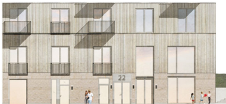
Fasadutsnitt för kvarter B mot Flygledargatan, med entrén till bostadshuset och förskolan i en markerad sockelvåning i tegel och fasad i trä. Illustration: Arkitema.
