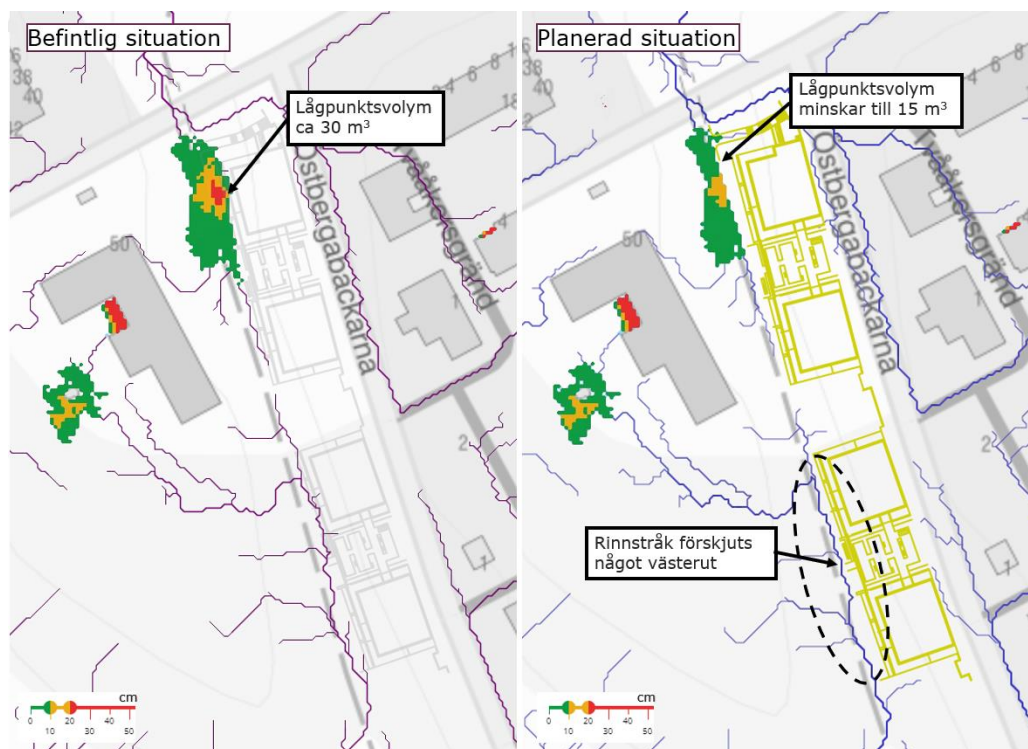
Figur 23 Jämförelse skyfallsvolym innan och efter exploatering, utan åtgärder (Scalgo Live, 2022)
