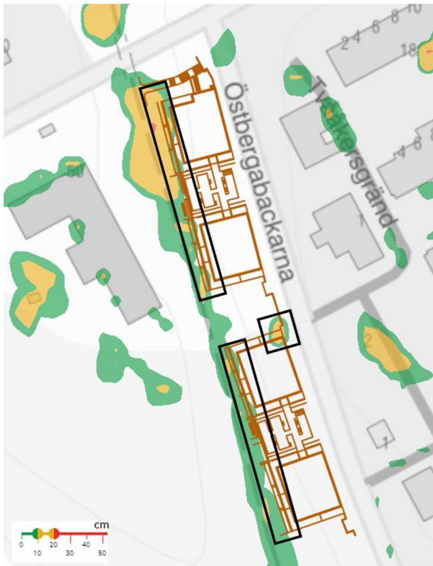
Figur 25 Planerad bebyggelse som riskerar att översvämmas vid skyfall om markens utformning förblir som i dagsläget markerat med svart (vattendjup enligt Stockholms stads skyfallskartering 2017-2018, >50mm).
