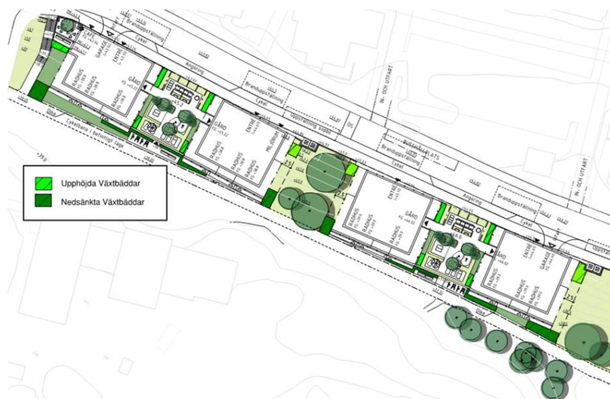
Figur 27 Föreslagen dagvattenhantering från kvartersmarksutredningen (Granitor, rev 2022-09-27)
