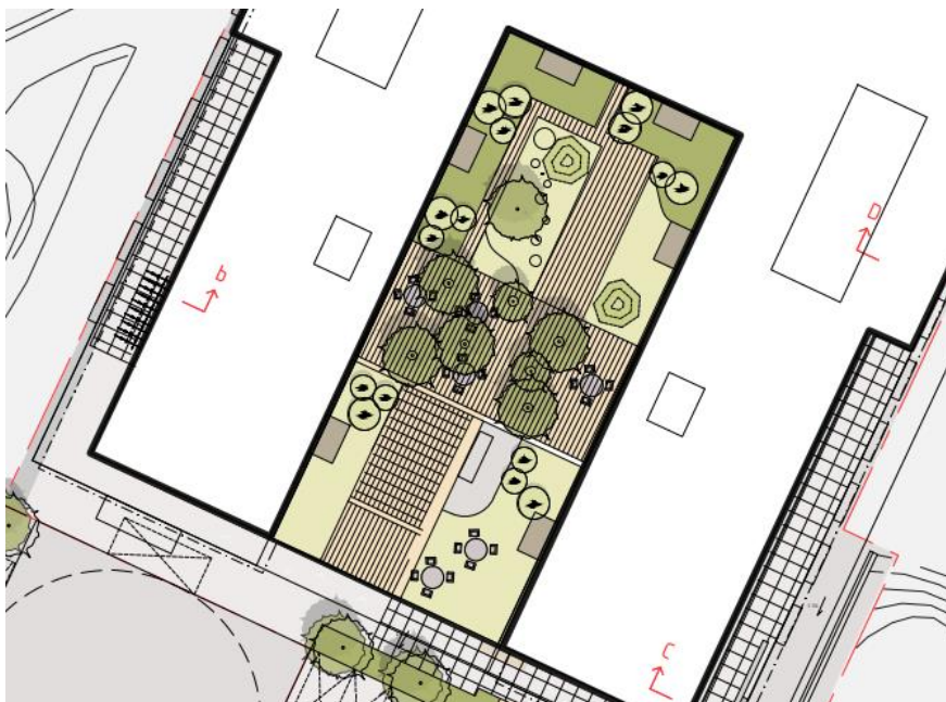
Figur 17 – Planerad grönskande innergård ovanpå bjälklag. Bild: Urbio
