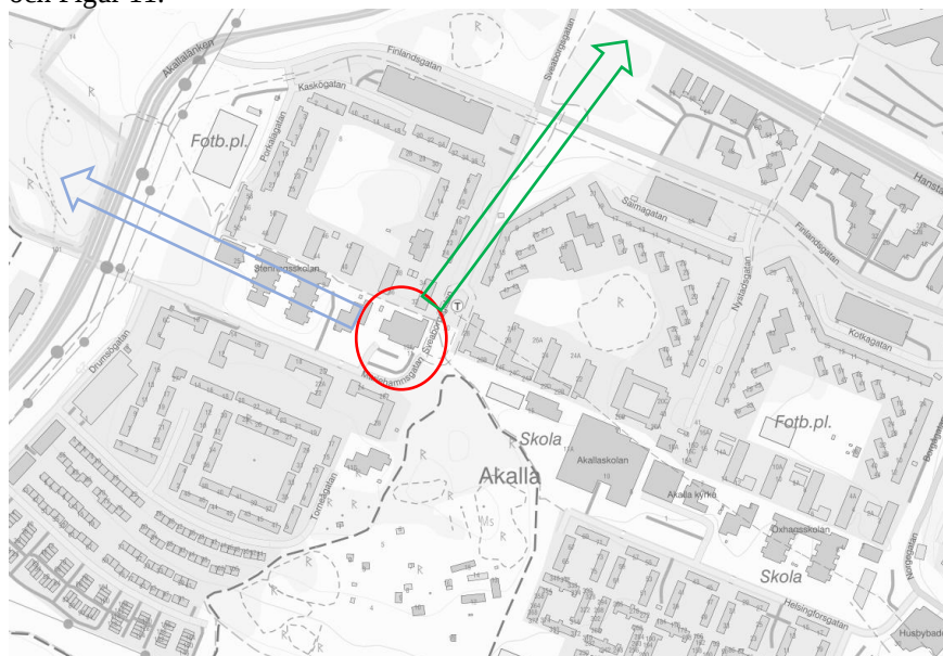
Figur 10 – Avrinningsriktningar. Planområdet markerat i rött avvattnas mot Edsviken via dagvattentunnel, ungefärlig riktning markerad med grön pil. Den naturliga avrinningsriktningen är västerut mot Igelbäcken, ungefärlig riktning markerad med ljusblå pil.
