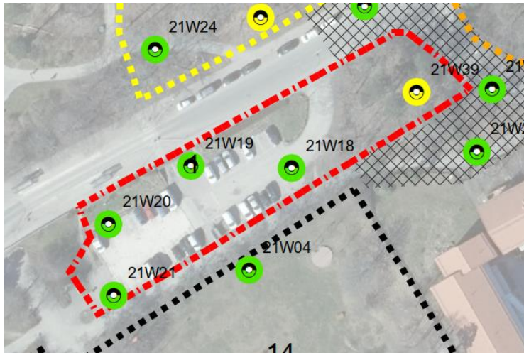
Figur 6-1. Översiktsbild över högst uppmätta halter i provpunkter inom delområde 1 (inom röd streckad linje), oavsett provtagningsdjup. Grön färg anger halter under KM och gul färg anger över KM men under MKM. Den västra delen av området kommer övergå till allmän platsmark/parkmark, väster om punkt 21W19.
