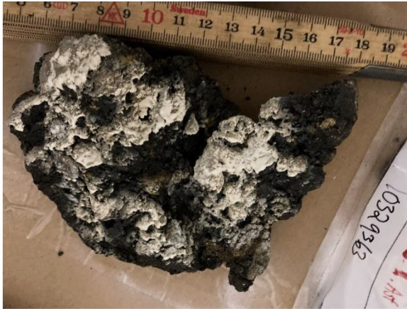
Bild 29. Asfalt från provpunkt 21W26
