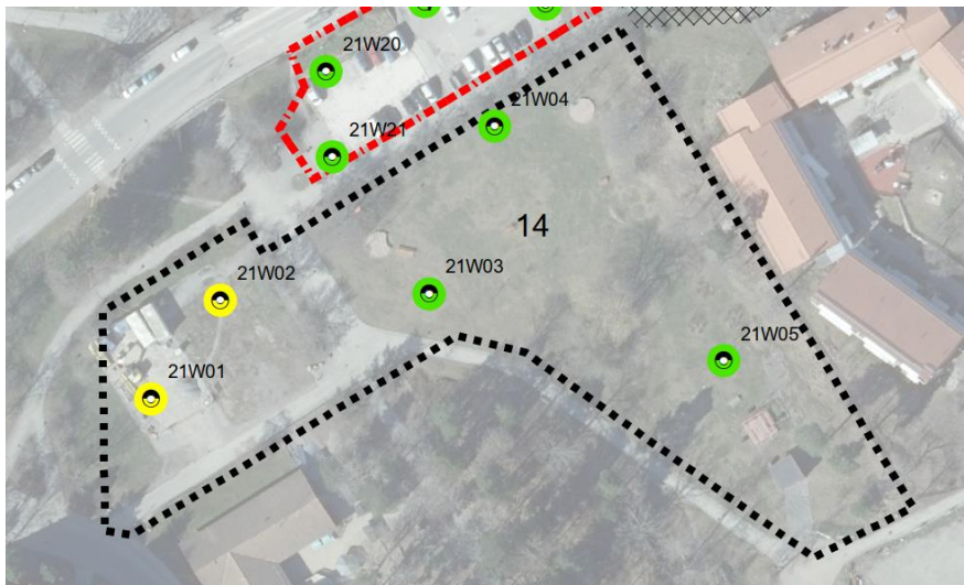
Figur 6-9. Översiktsbild över högsta uppmätta halter i provpunkter inom delområde 14 (inom svart streckad linje) oavsett provtagningsdjup. Grön färg anger halter under KM, gul färg anger halt över KM men under MKM.
