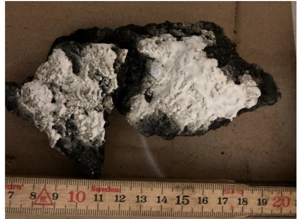
Bild 30. Asfalt från provpunkt 21W27
