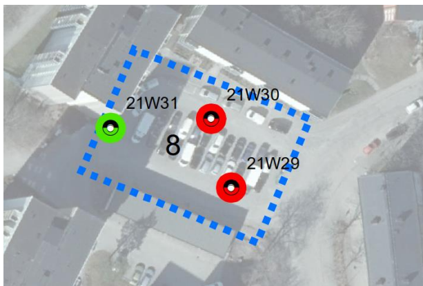
Figur 6-5. Översiktssbild över högst uppmätta halter i provpunkter inom delområde 8 (inom blå streckad linje), oavsett provtagningsdjup. Grön färg anger halter under KM, röd färg anger halt motsvarande farligt avfall (FA).
