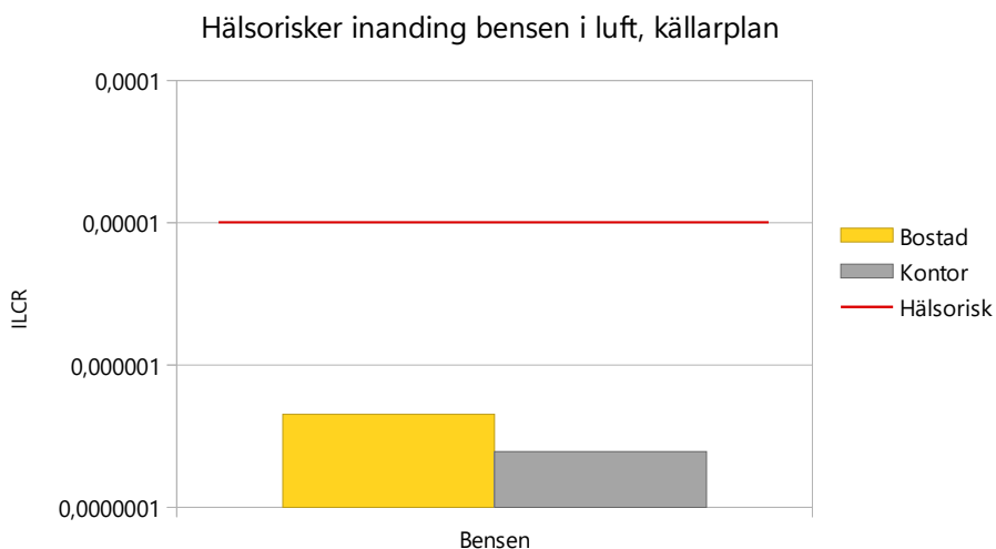
Figur 3: ILCR för bensen i inomhusluft i källarplan jämfört mot hälsorisknivå. Observera att y-axeln är logaritmisk.
