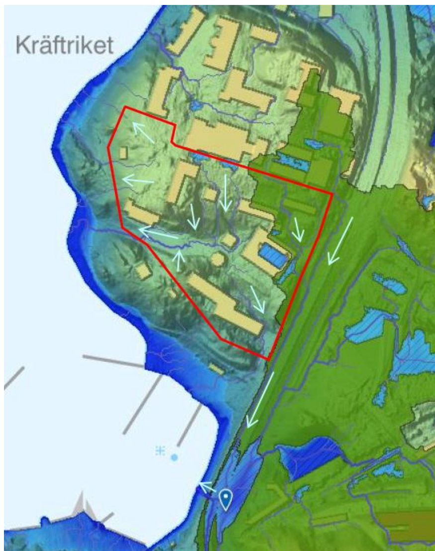
Figur 9. Mörkblå linjer visar rinnvägar inom planområdet (röd polygon). Grönt område visar avrinningsområde till lokal lågpunkt söder om planområdet. Ytlig avrinning sker mot Brunnsviken (bild från Scalgo Live).
