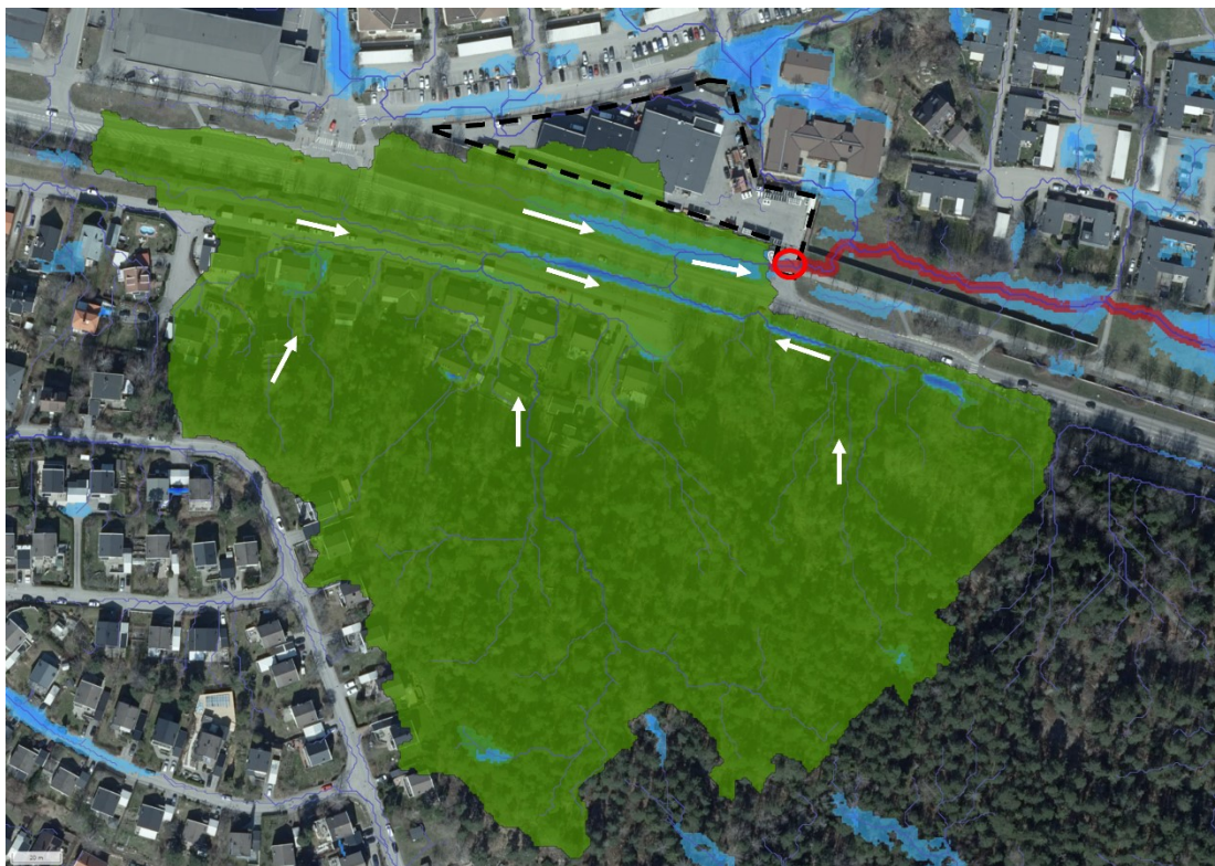
Figur 11. Avrinningsområde uppströms söder om planområdet som rinner till fastigheten är markerat i grön färg och flödesvägarna med vita pilar. Sträckan där flödesstråket passerar planområdet är markerat med röd cirkel.
