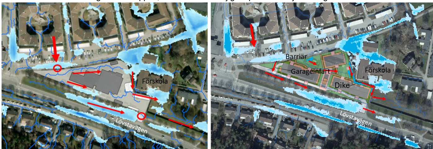
Figur 20. Flödesriktningar i befintlig situation (t.v.) och förslag till flödesriktningar i planerad situation (t.h.)
