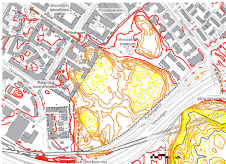
Kartbild över befintlig mark inom planområdet. Röda linjer redovisar nivåer upp till +29, orangea linjer nivåer upp till +34, och gula nivåer upp till +38 (RH2000). Bild av WSP.
