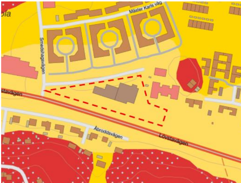
Figur 2. Utdrag ur SGU:s jordartskarta, med provtagningsområdet ungefärligt markerat. Gula ytor utgörs av postglacial lera, röda ytor utgörs av urberg, ljusblå prickar utgör ett tunt moräntäcke ovan urberg.
