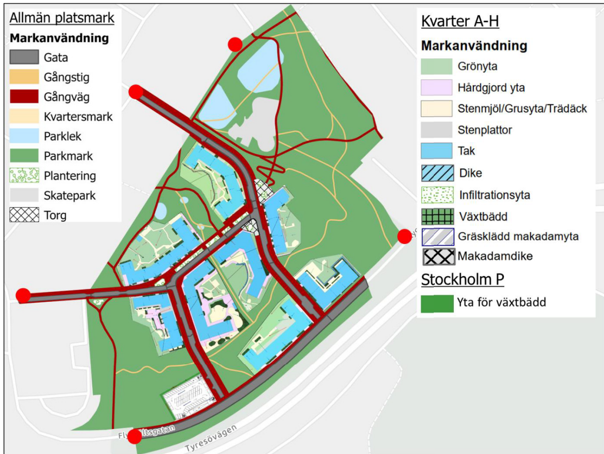
Figur 35. Översikt över dagvattenhanteringen i planområdet och förslag till anslutningspunkter till befintligt ledningsnät (röda prickar).
