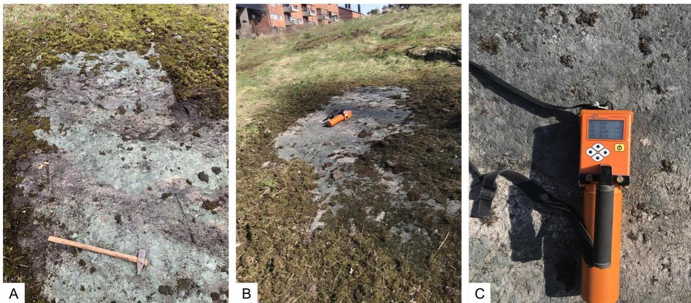
Figur 7: A. Rödomvandlad sedimentär gnejs. B. Radonmätning på ytan. C. Mättningsresultat; Kalium, Uranium Torium och DR halt.
