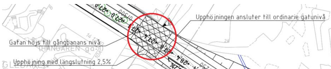
Figur 12 Upphöjd gata vid anslutning till parkstråk norr om området.
