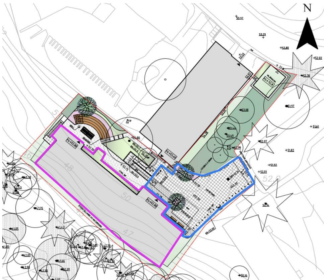
Figur 13. Skiss över planerad dagvattenhantering. Blå linje markerar vilka ytor som ska ledas till fördröjningssmagasinet. Lila markering visar den takyta som leds till lågstråket med de befintliga träden, avrinningen av dagvatten från halva taket leds dock först via regnbädden.
