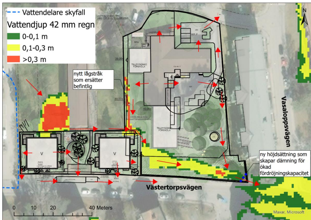
Figur 20. Vattendjup vid skyfall sam flödesvägar inom kvarter 2 och förskolan med omnejd efter omdaning. Upplösning av höjdmodell 1x1m (RH2000).
