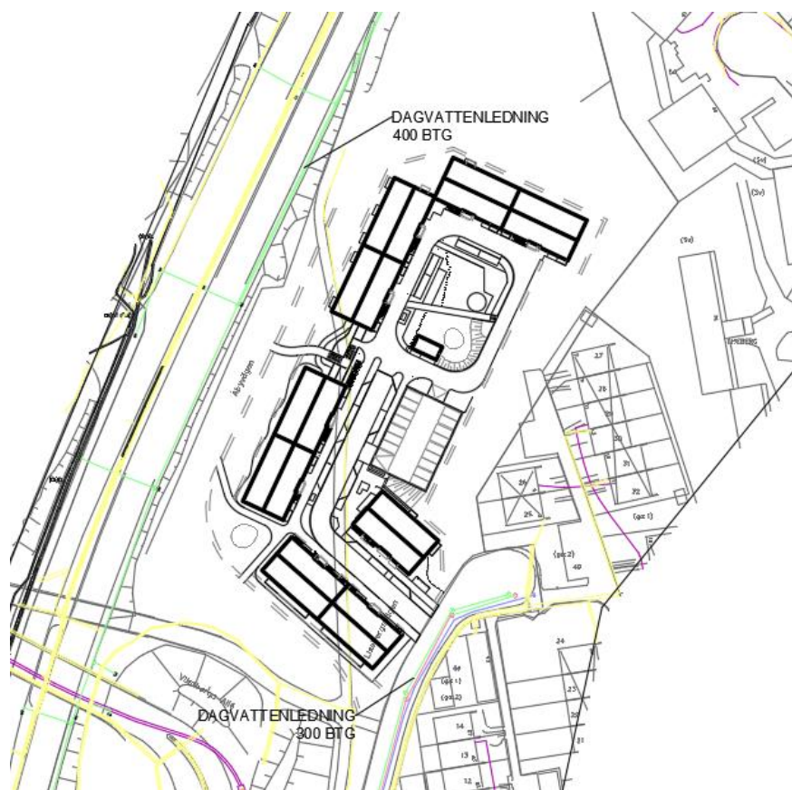
Figur 5. Dagvattenledningar i området.
