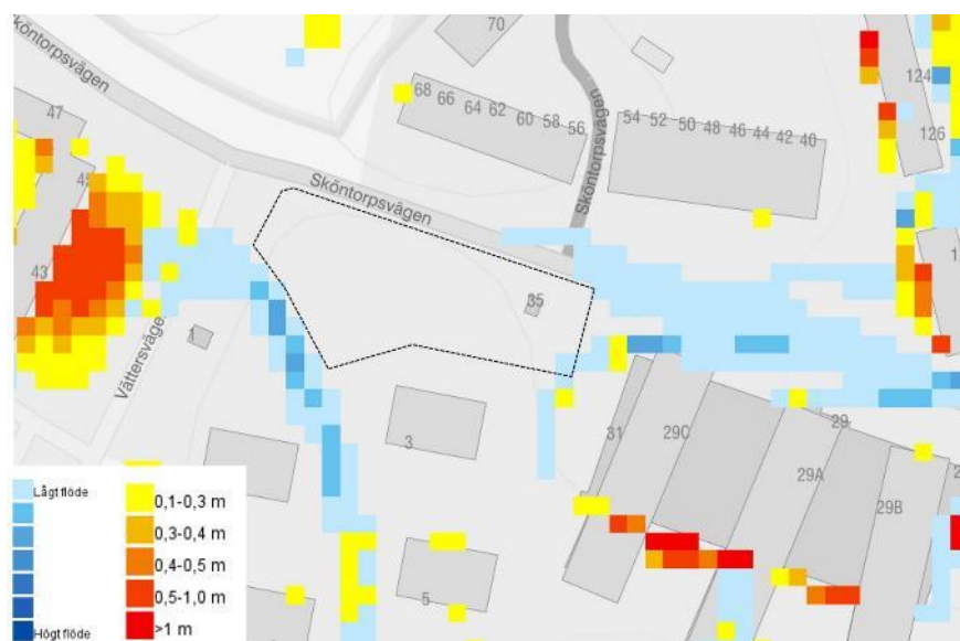
Figur 13. Modellerade avvattningsvägar och vattendjup vid skyfall. Källa:(Miljödataportalen, 2022).
