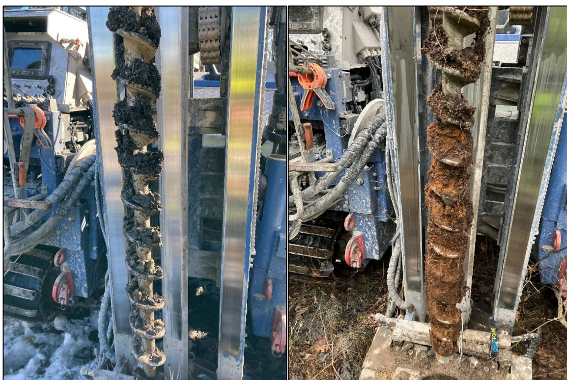
Figur 5-1. Grovt fyllnadsmaterial främst bestående av sten i 22GS18.
