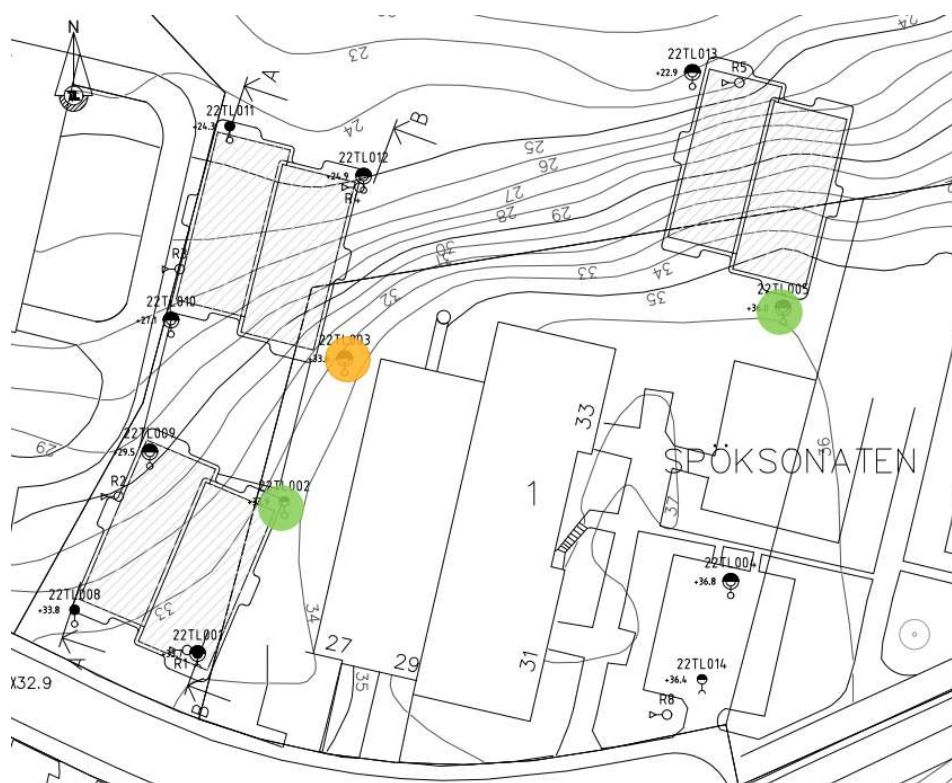
Figur 10-1 Placering och resultat från kaxprovtagning. Gröna cirklar representerar svavelvärden understigande 1000 mg/kg och gula cirklar representerar svavelvärden överstigande 1000 mg/kg
