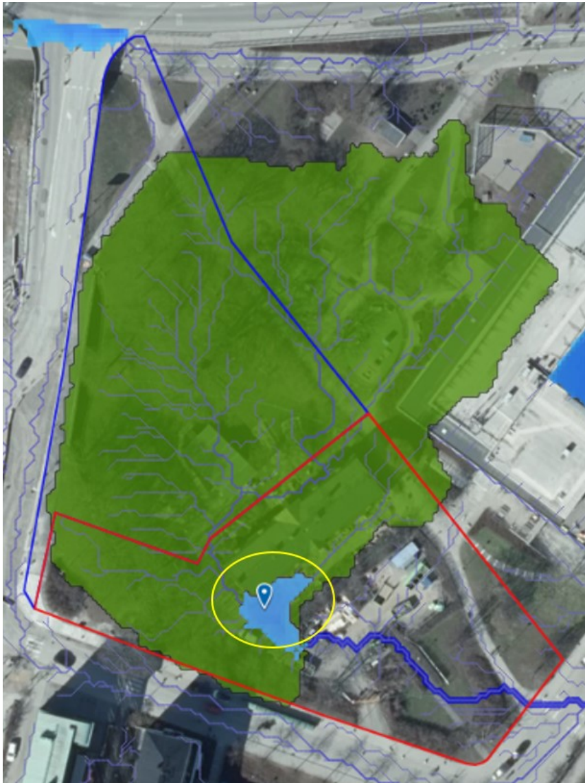
Figur 16: Ungefärlig fastighetsgräns (röd linje), allmän platsmark (blå linje), lågpunkt (gul ring) samt tillrinning till lågpunkt (grönt område) (ScalgoLive 2022). Bakgrundskarta: ArcGIS.
