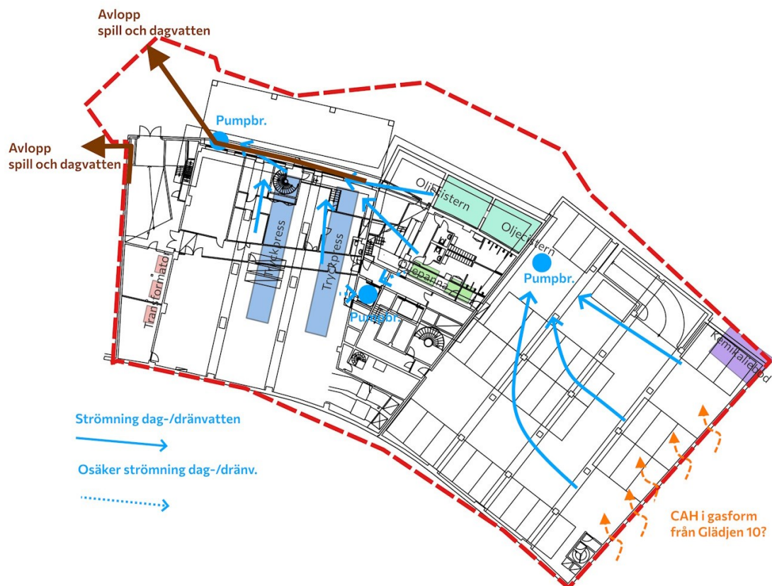
Figur 18. Modell över verksamheter i källarplan som kan ha skapat markföroreningar under byggnaden samt avloppsledningar från verksamheter som laboratorier läkemedelsindustri, fotolabb och tryckeri plan 3–7. CAH är klorerade alifater i gasfas från närliggande Glädjen 10.
