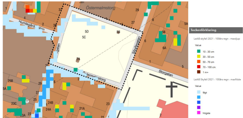
Figur 6. Utsnitt från Länsstyrelsens skyfallskartering där flödesvägar redovisas med blått och stående vatten på markytan redovisas med grönt. Utredningsområdet redovisas med svart streckad linje (Structor, 2023).
