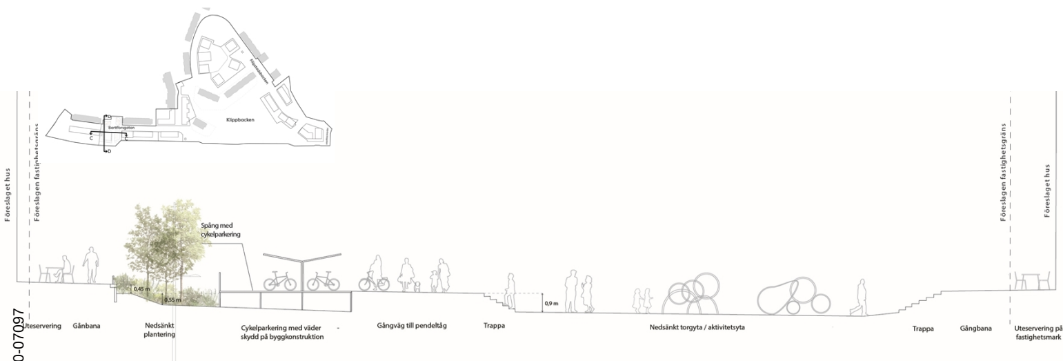
Sektion C-C (öst-västlig) som visar utformning av torget vid Brattforsgatan. Bild: WSP
