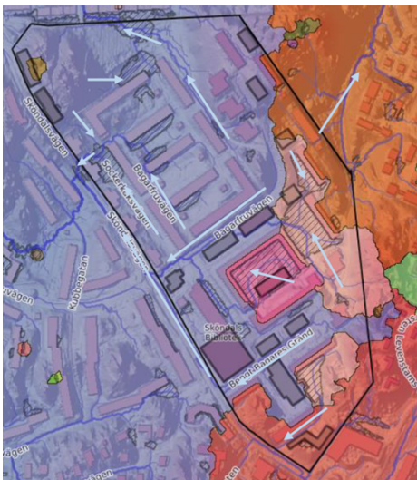
Utklipp från Scalgo Live som visar framtida avrinningsområden (olika ytor i färg) och avrinningsvägar i utredningsområdet. Ny bebyggelse är märkt med svarta kanter. Blå linjer visar flödesvägar, pilar visar flödesriktningar och streckade område markerar fördjupningar i terrängen. Bild: COWI.
