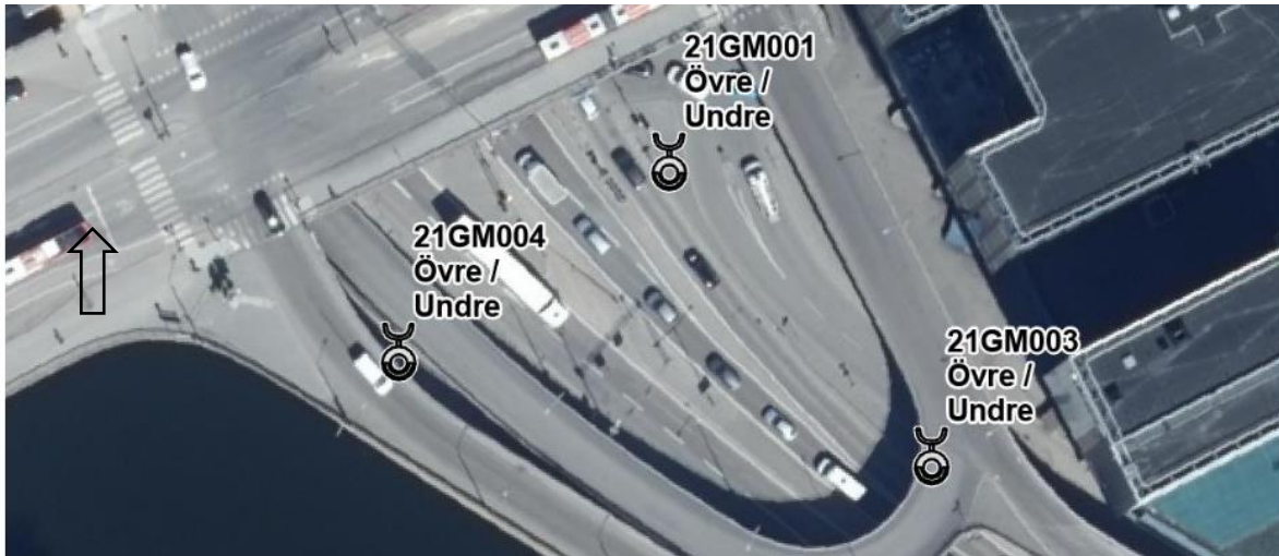
Figur 4-5. Placering av undersökningspunkter för grundvattnen inom KCV området. Beteckning visar att i undersökningspunkten finns både ett grundvattenrör i det övre grundvattenmagasinet och i det undre grundvattenmagasinet. Källa: Miljö- och hälsoriskbedömning, Sweco 240920.
