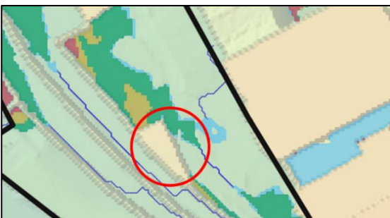
Figur 10 Vattendjup kring det planerade driftsrummet vid ett skyfall (56 mm regn).
