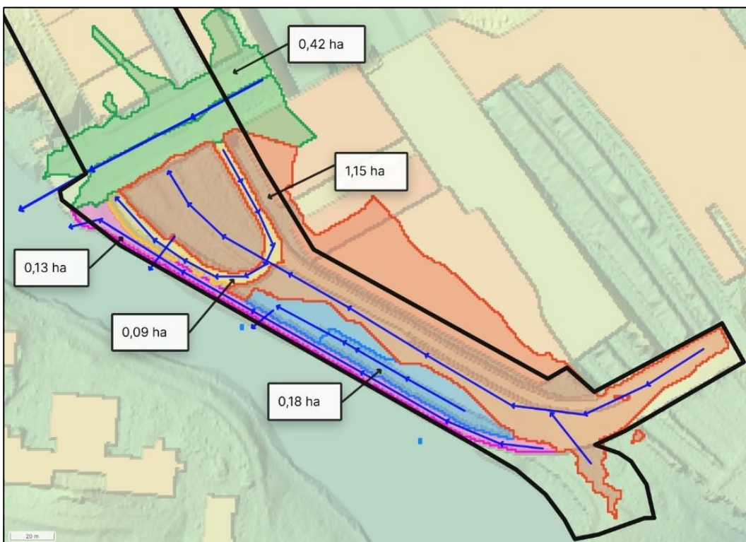
Figur 2 Flödesriktningar (blå pilar) och avrinningsområden (färgade) inom och i närheten av utredningsområdet (svart). Befintlig situation, bronivå.
