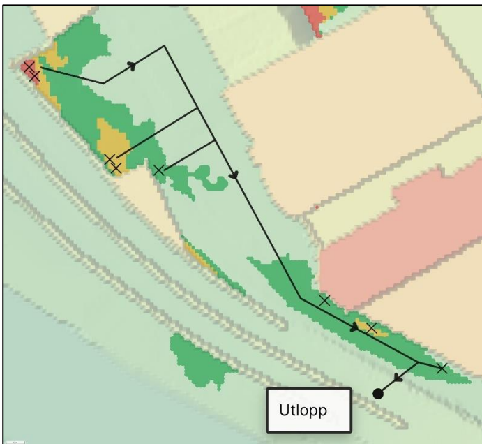
Figur 13 Vattendjupet vid planerad situation med planerade dagvattenbrunnar visas med kryss och ledningar med linjer.
