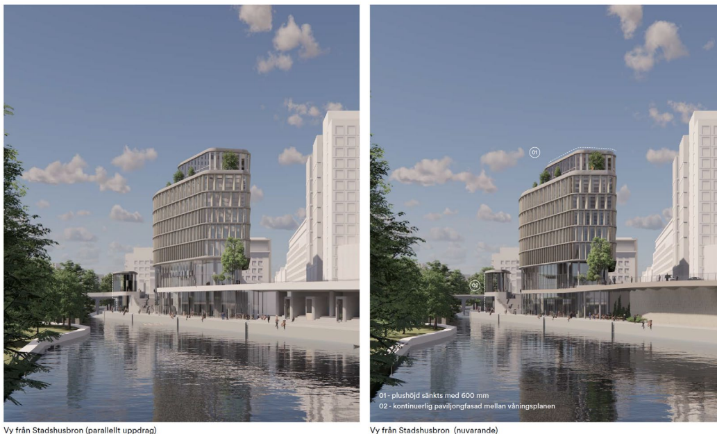
Figur 10. Skillnader i Klara City View från det parallella uppdraget (ses till vänster i figur) till nuvarande utformning (ses till höger i figur). Skillnaderna rör sänkning av takfotshöjden (01 i figur) samt justering av paviljongens fasad (02 i figur) (Dorte Mandrup, 2024).
