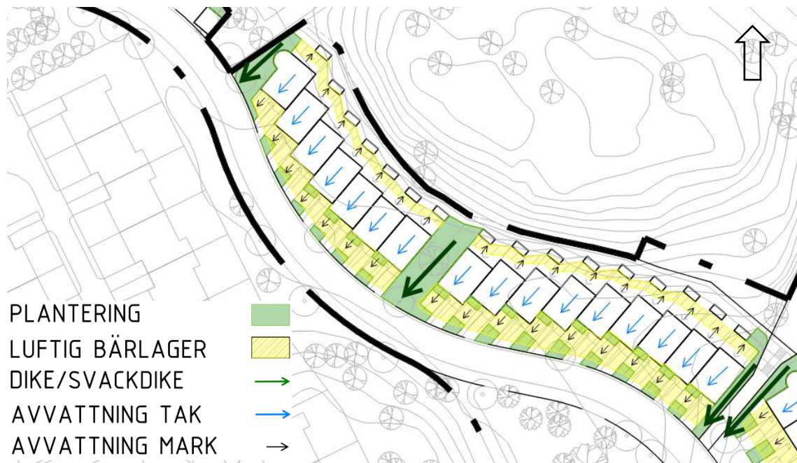
Figur 11. Avvattningsprincip för kvartersmarken.
