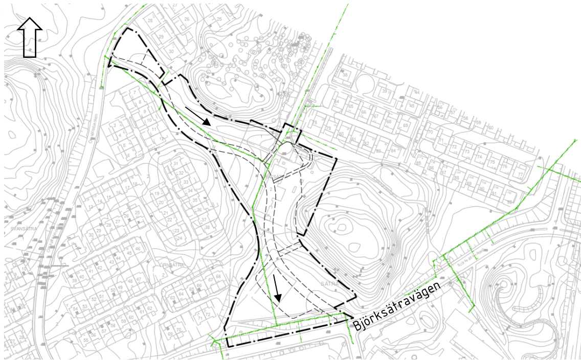
Figur 4. Befintligt dagvattennät inom planområdet. Svarta pilar visar ledningsriktningen.
