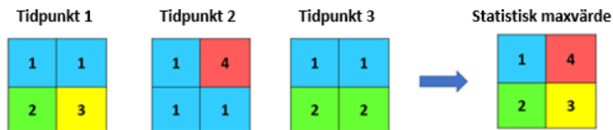
Figur 5: Visualisering över hur statistiskt maximalt vattendjup beräknas.
