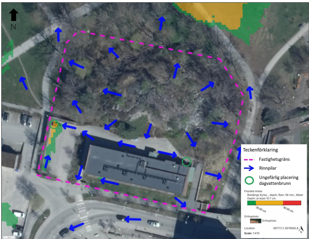
Figur 7.1. Flöden vid händelse av ett klimatkompenserat 100-årsregn följer samma princip som dagvattenflödena enligt analys i SCALGO Live. Det finns ett mindre instängt område på fastighetens parkering i väster, där en av de två befintliga dagvattenbrunnarna är placerade. Vattendjupet i det instängda området är som högst 0,2–0,25 m.
