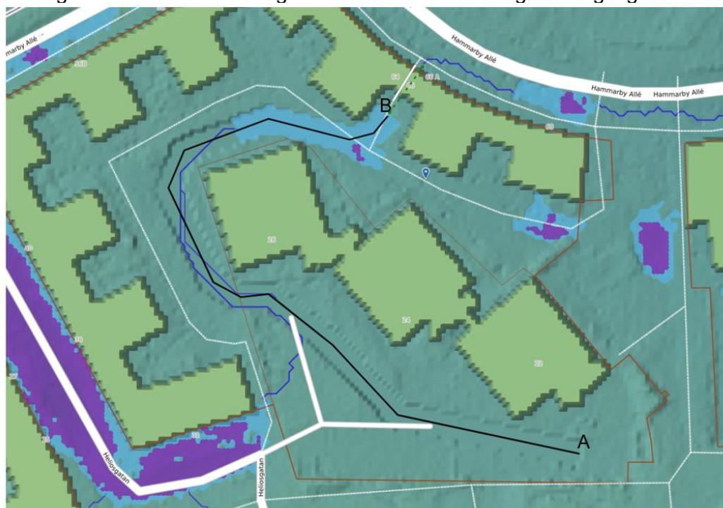
Figur 22 Flödesvägar och vattenansamlingar efter simulerad åtgärd (linje A till B). Ljusblå färg visar vattendjup 70 mm vattendjup <70 mm. Blå pil visar lutning på simulerad åtgärd. Baserat på de naturliga flödesvägarna skulle även översvämning Heliosgatan kunna undvikas/minimeras om samarbete sker med staden och en liknande åtgärd genomförs för att avvattna gaturnen.
