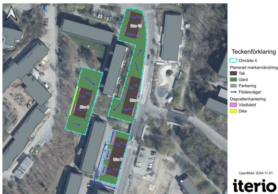
Figur 21. Förslag på dagvattenhantering för område 4.
