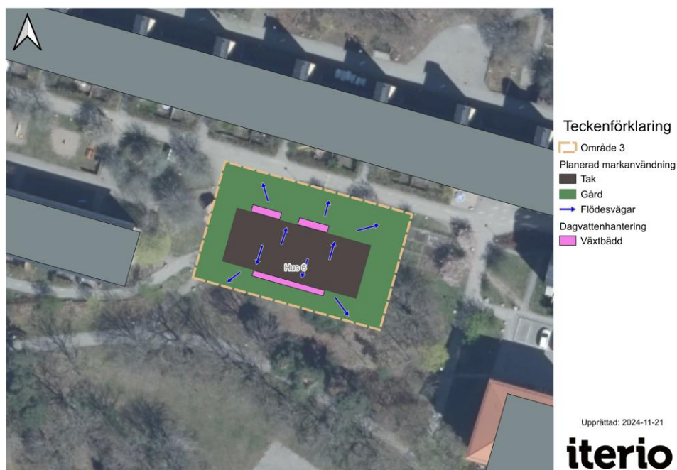
Figur 20. Förslag på dagvattenhantering i område 3.
