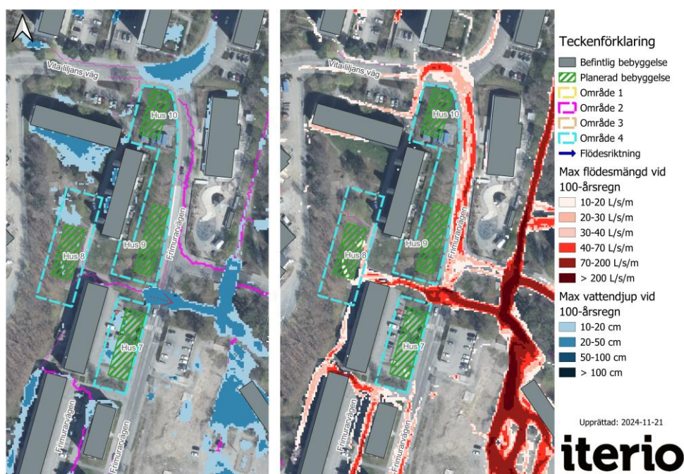
Figur 17. Maximalt vattendjup, utbredning och flödesmängd vid ett 100-årsregn för område 4 i befintlig situation. Vatten rinner i gångtunnel under Frimurarvägen mellan hus 7 och 9.
