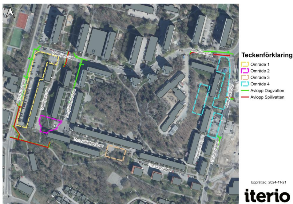
Figur 13. Befintliga allmänna dag- och spillvattenledningar kring planområdet.
