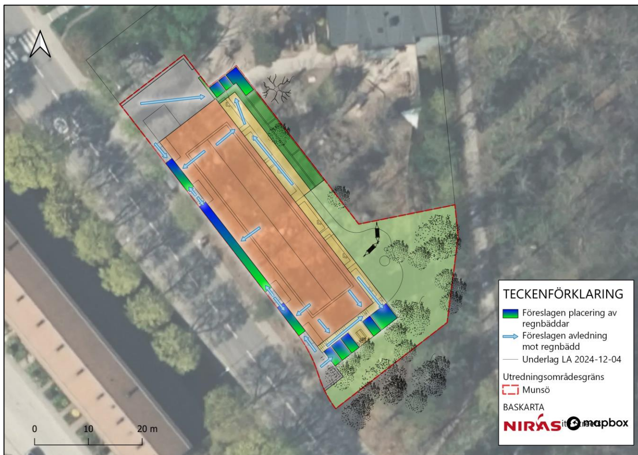
Figur 8.1 Möjliga placeringar av föreslagna dagvattenåtgärder, regnbäddar, i anslutning till takytor, hårdgjord parkering/infart samt terrass/entréområde. Detta är enbart schematiskt och överstiger det beräknade ytbehovet, men kan ses som möjliga ytor. Detaljerad höjdsättning och planering av bostäder bör säkerställa att vatten omhändertas i regnbäddar.
