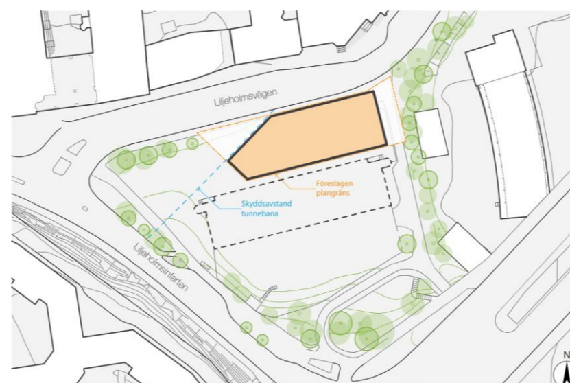
Figur 6. Föreslaget ny fördelningsstation inom Detaljplan Liljeholmen 1:6 och del av Liljeholmen 1:1. Befintlig tryckpunktstation illustreras med svart, streckad linje, söder om nytt föreslaget läge.
