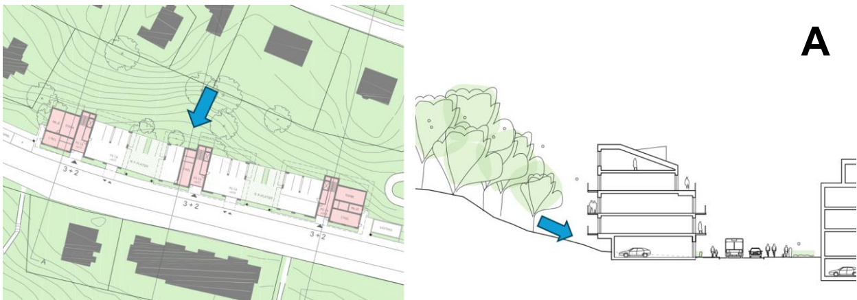
Figur 18. Situationsplan och sektion av delområde A med flödesriktning markerad med blå pil (ALFA Development, 2024).
