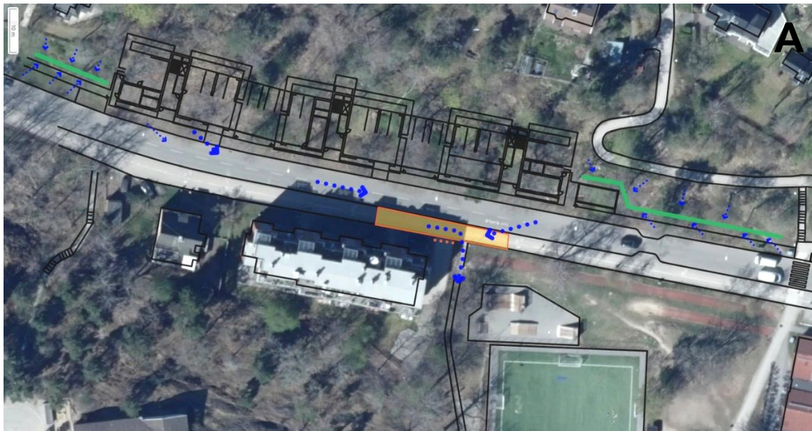
Figur 26. Förslag på skyfallshantering för tillkommande hårdgjord yta i allmän platsmark vid delområde A. Grön linje visar diken med magasinierande kapacitet och blå streckade pilar visar flödesväg till dike eller vidare mot yttligt fördröjningsmagasin. Orange rektangel visar justerad sträcka av GC-bana och gul streckad linje är gupp framför Aldermannen 48.
