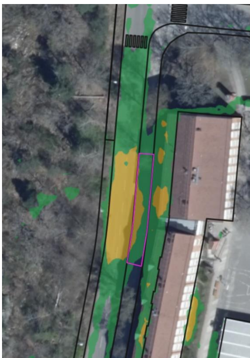
Figur 22. Lågpunkt längs Slättgårdsvägen framför Mälarhöjdens skola som enligt Stockholm stads skyfallsmodell beräknas översvämmas mer 20 cm, vilket blockerar framkomligheten till delområde A vid framtida 100-årsregn. Föreslagen area för korrigering av GC-bana är markerad i magenta. Grönt indikerar översvämningsdjup på 5-20 cm och gult översvämningsdjup 20-50 cm (Trafikkontoret, Stockholms stad, 2024).
