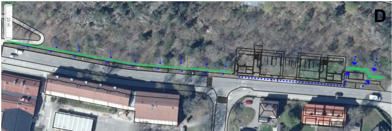
Figur 25. Förslag på skyfallshantering för tillkommande hårdgjord yta på allmän platsmark vid delområde D. Grön linje visar diken och blå streckade pilar visar flödesväg till dike.
