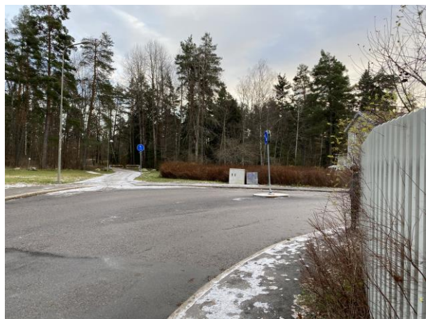
Figur 18. Rusthållarvägen i planområdets avslut, där gatan svänger kraftigt med begränsad sikt. Även staket på befintlig fastighet påverkar sikten i kurvan. I bakgrunden ses entrén till Nackareservatet.
